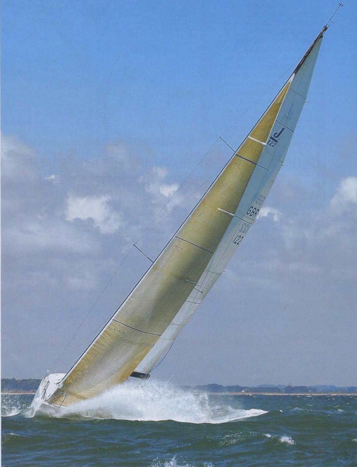
au près quand le voilier serre le vent, elle est décalée progressivement par le chariot et/ou l'écoute de grand-voile au fur et à mesure que le barreur abat. Mais au-delà du vent de travers sur un bateau de croisière, l'incidence par rapport au vent apparent va dépasser les 20° pour atteindre 40° au largue et 80-90° au vent arrière, allures où les voiles agissent uniquement en poussée et non en écoulement laminaire.
