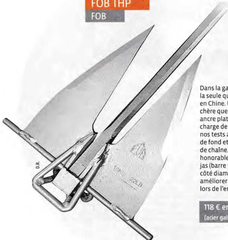
Dans la gamme FOB, c'est la seule qui soit fabriquée en Chine. Un peu moins chère que la FOB HP, cette ancre plate a tenu une charge de 900 kilos lors de nos tests avec 2,50 mètres de fond et 12 mètres de chaîne. Un résultat honorable, sans plus. Le jas (barre transversale côté diamant) est censé améliorer la stabilité lors de l'enfouissement.
