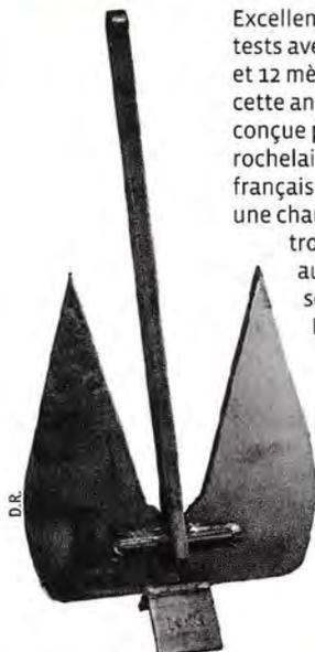
Excellent résultat, lors de nos tests avec 2,50 mètres de fond et 12 mètres de chaîne, pour cette ancre plate toute simple conçue par Tecmar - une société rochelaise qui est le distributeur français de Lewmar. Elle a tenu une charge de 4 tonnes! On trouve aussi ce modèle au catalogue de Lewmar, sous le nom de LFF.
