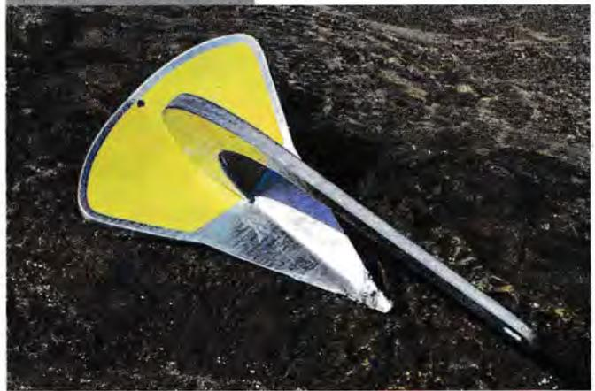
Ce n'est pas la première fois : lors de ce test comparatif, l'ancre Spade s'est à nouveau distinguée par ses performances. Avec 2,50 mètres de fond et 12 mètres de chaîne, elle a semblé être au-dessus du lot, en crochant tout de suite et en tenant une charge de plus de 3 tonnes, malgré la présence de quelques galets, et bien que les fonds présentent une légère pente défavorable... Les ancres Spade
